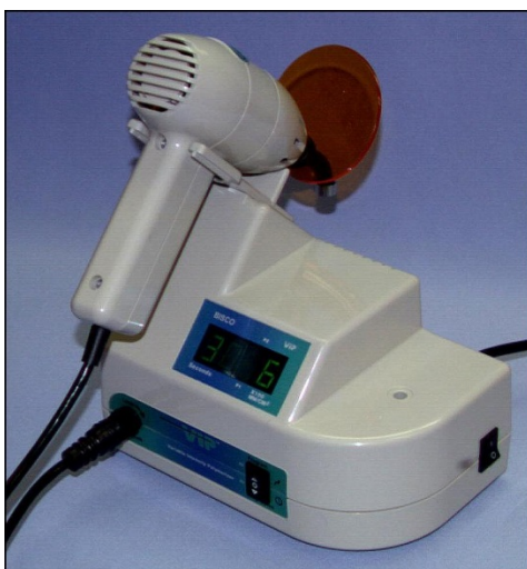
그림 10. VIP curing unit. 광조사 세기를 100 mW/cm 2 씩 조절할 수 있다.
