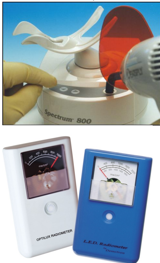
그림 8. 광조사기의 광도를 주기적으로 확인하는 것이 중요하다. 광도를 측정하는 장치를 radiometer라고 하는데 광조사기에 달려있거나 별도로 구매하여
