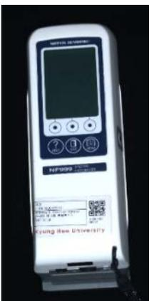
그림 2 색채값 측정에 이용한 spectrophotometer(NF99, NIPPON DENSOKU)
